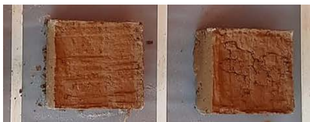
Figura 4. Comparação fissuração bloco com acréscimo de fibras(esquerda) com bloco sem acréscimo de fibras(direita) (crédito: V. Fasciotti)
